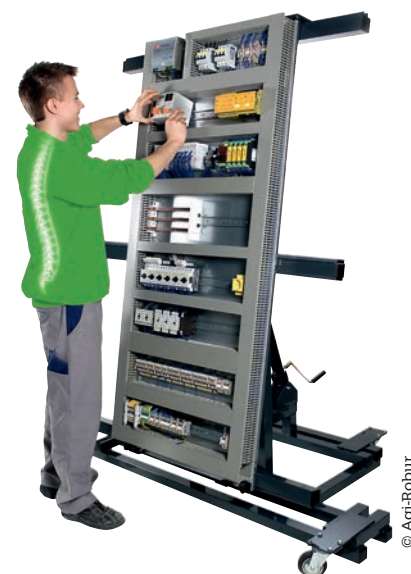
▲ Table de montage orientable pour électricien.
